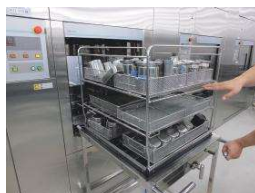
高圧蒸気滅菌装置への搬入
